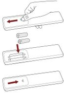
1. Deslice la cubierta trasera para abrir el compartimento de pilas del control remoto.
